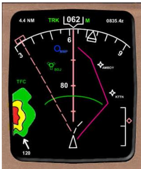
Фигура 2.7 Зелената дъга на Boeing показва хоризонталната позиция, при която се извършва достигане на височината, използвайки прост алгоритъм за линейна екстраполация
