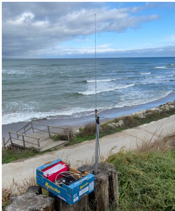
Фиг. 1.1. Районът на Фар Шабла, изследване на AIS покритието с мобилната установка, включваща AIS receiver Em-Trak R300, VHF23 Marine Antenna и Raspberry Pi 5
