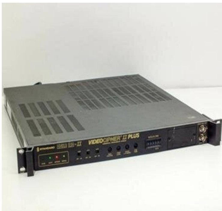
Фиг. 3.2. Video Cipher scrambler устройство, защитаващо аналогово съдържание за телевизионни оператори.
