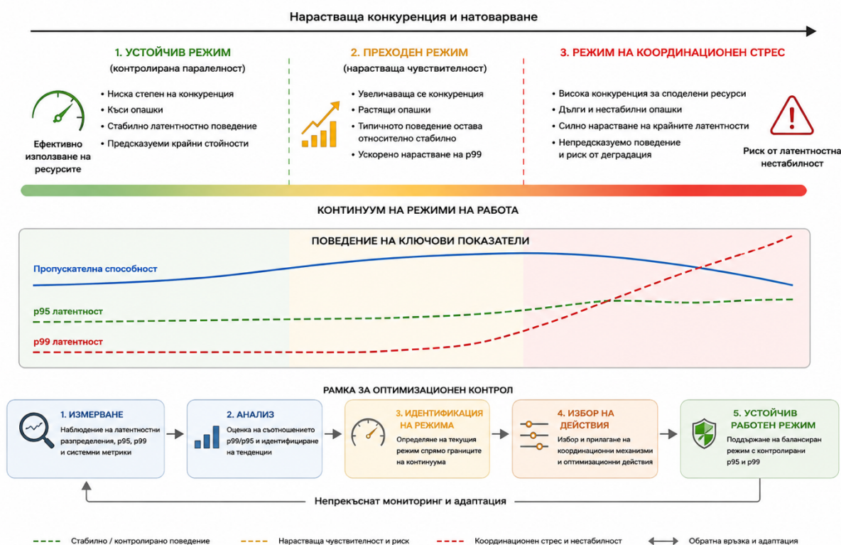
Фигура 23. Режим на работа по пътя на записа при нарастваща конкуренция - от стабилно поведение към координационен стрес
