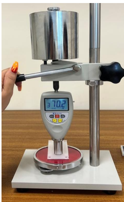
Фиг. 3.6 Уред за измерване на микротвърдостта по Шор.(описан в глава 2)
