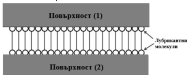
Фиг.1.15. Илюстрацията на граничното смазване показва монослой от смазочни молекули, абсорбирани и ориентирани върху свързващите повърхности.
