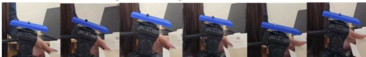
Фигура 4.6. Снимки от експеримента по намиране на коефициент на триене при търкаляне
