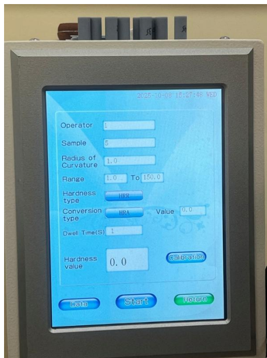
Фигура 4.16 Контролен панел на твърдомер EBP BRV-187.5T
