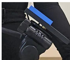
Фигура 4.5.: Снимка от експеримента по определяне на коефициента на триене при плъзгане TPU+HIPS
