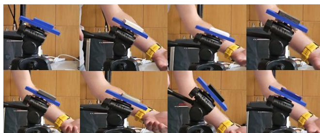
Фигура 4.4 Снимки от експеримента за намиране коефициент на триене при плъзгане
