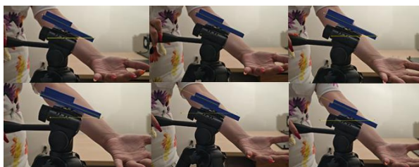
Фигура 4.3. Снимки от експеримента за намиране коефициент на триене при плъзгане
