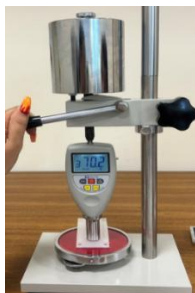
Фиг. 3.6 Уред за измерване на микротвърдостта по Шор.(описан в глава 2)
