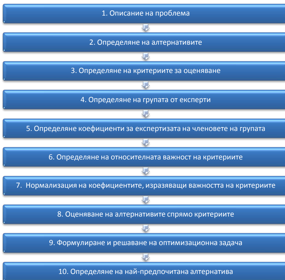
Фиг. 2.4. Алгоритъм за прилагане на модифицирания математически модел на SMART за групово вземане
