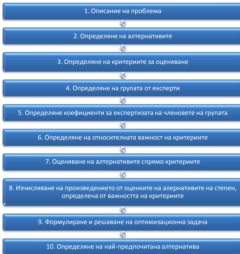
Фиг. 2.3. Алгоритъм за прилагане на модифицирания модел на претегленото произведение за групово вземане на решение
