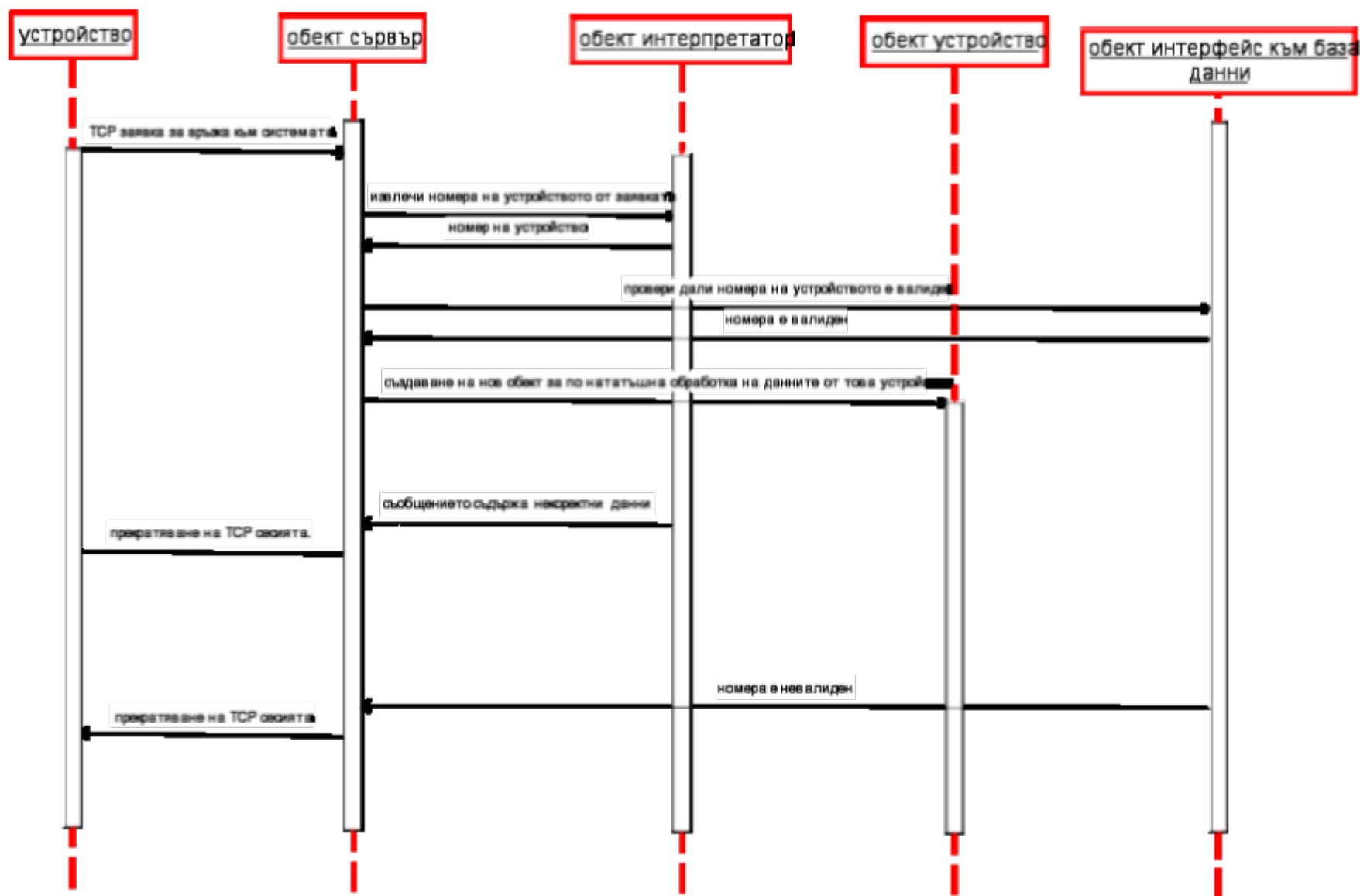
диаг. 1 Работа на сървърният обект при приемане на заявки за връзка от устройствата
