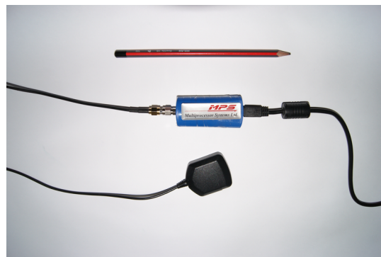
Фиг. 2.45. Експериментална апаратура за регистрация на GPS сенките
