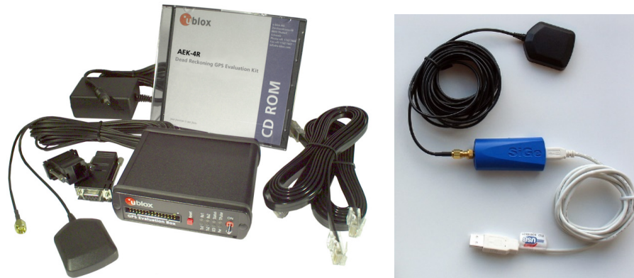
Фиг. 2.27. Експериментална апаратура за регистрация на GPS сенките
