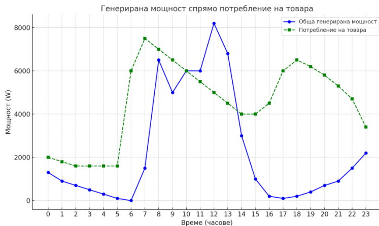
Фиг. 4.3 Общо производство на електроенергия и консумирана енергия (за 24-часов период)
