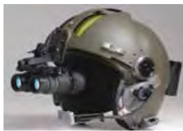
Фиг. 1.23. Външен вид на бинокулярни УНВ, предназначени за управление на летателни апарати
