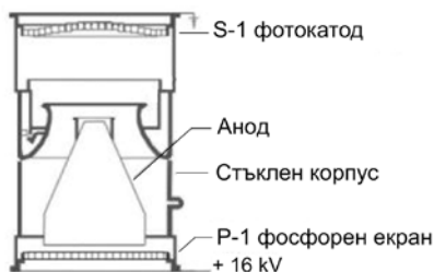
Фиг. 1.9. Структура на ЕОП от нулево поколение
