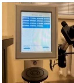
Фигура 4.17 Твърдомер EBP BRV-187.5T с монтирания индентор използван в изследването
