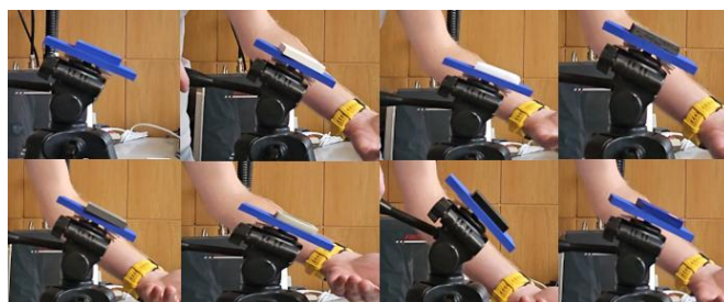
Фигура 4.4 Снимки от експеримента за намиране коефициент на триене при плъзгане
