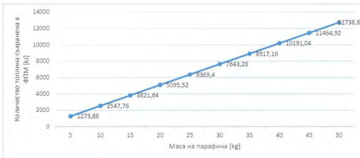
Фигура 4.2 Количество топлина съхранено в парафина в зависимост от масата
