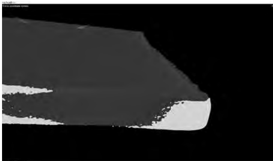
Фиг.4.18 Сканирано пробно тяло с усенък след шанцоване Фиг. 4.19 Усенък на образец след шанцоване
