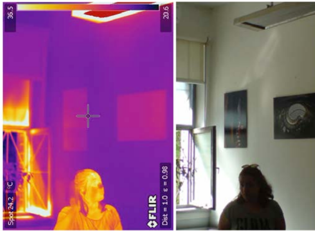
Фиг. 63: Отопление чрез лъчист отоплител
