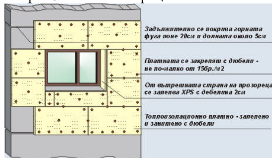
Фиг. 31: Монтаж на изолационни платна
