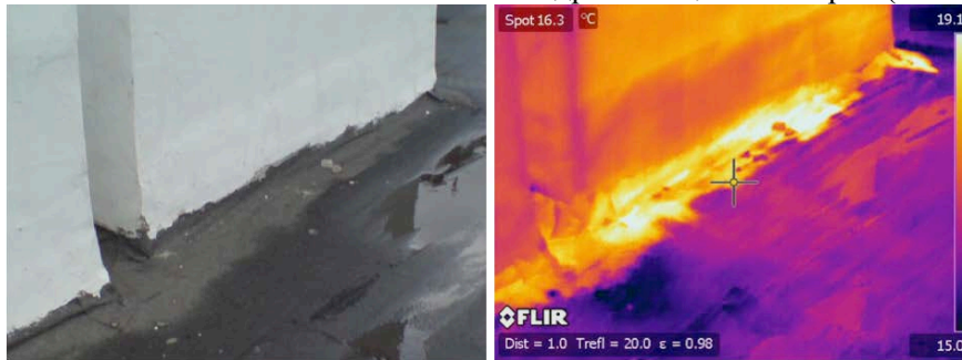
Фиг.67: Компрометирана хидро и топлоизолация на покрив
