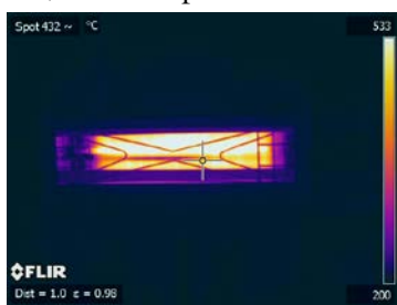
Фиг.64: Снимка с термокамера на работеща конвекторна печка
