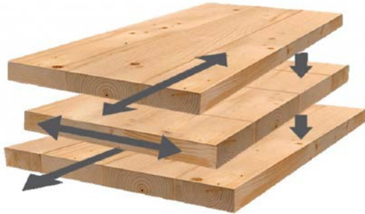
Фиг. 55: Принцип на сглобяване на CLT панел
