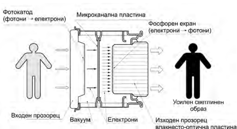
Фиг. 1.5. Принцип на работа на ЕОП
