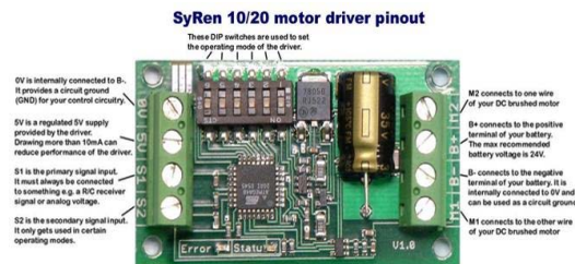
Fig. 8. SyRen motor controller
