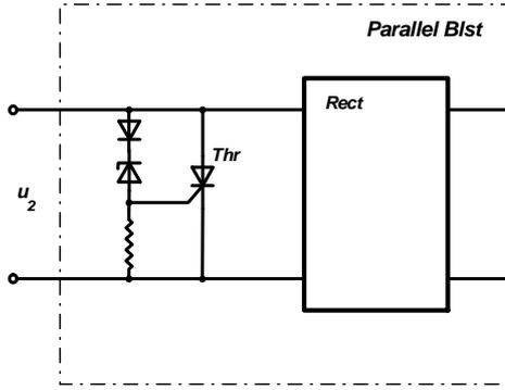
Fig. 8. Parallel-Type Ballast Blst
