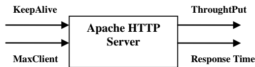
Фиг. III.4. Apache HTTP Server, представен като система за автоматично регулиране
