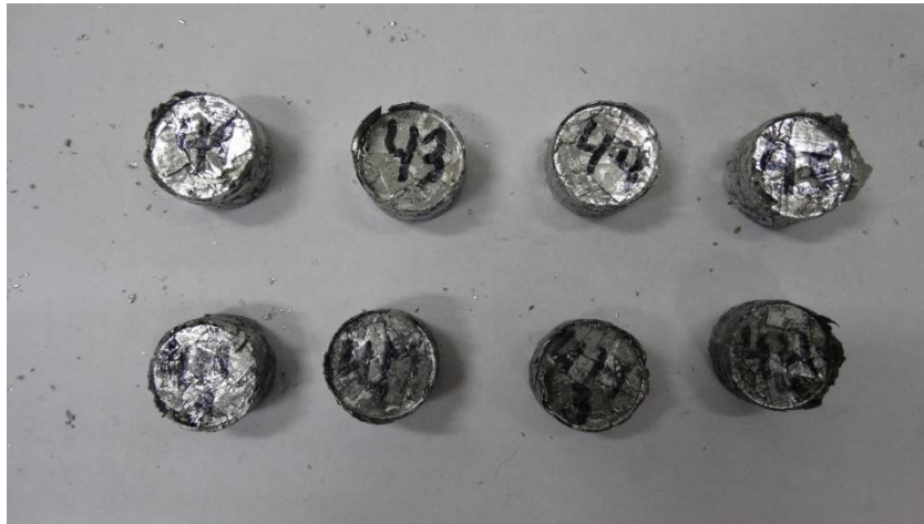
Фигура 72. а – брикети от алуминиеви стружки (А1 – А4 от почистени стружки; АМ1 – АМ4 от стружки във вид на доставка); б – брикети от чугунени стружки (Ч1 – Ч4 от почистени стружки; ЧМ1 – ЧМ4 от стружки във вид на доставка )
