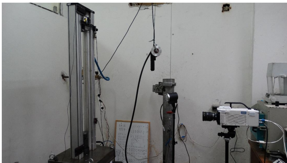
Фигура 14. Лабораторен стенд за сложен удар с високоскоростна камера
