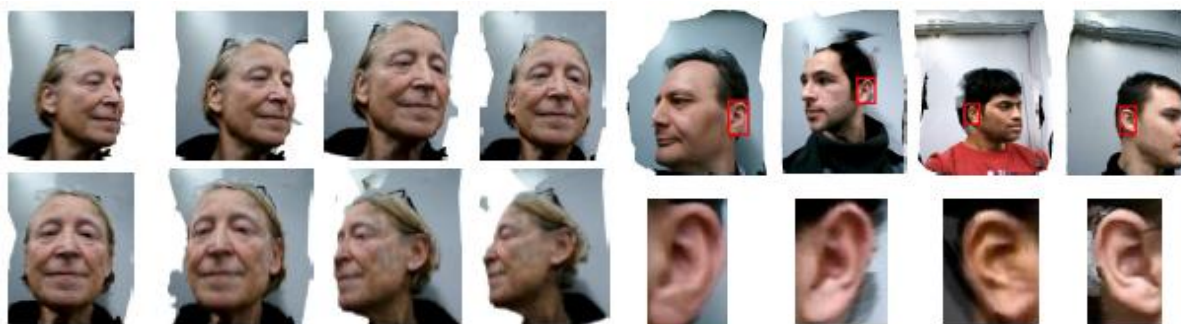
Фиг. 68. 3D реконструкция на физиономии, заснети чрез предната камера (0.3 мегапиксела) на Google Nexus S смартфон: а) многоизгледна 3D реконструкция на лице; б) детекция и сегментация на уши от 3D профил на лице.
