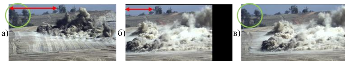
Фиг. 33. Стабилизация на видеоклип на контролиран взрив: а) първи кадър; б) последен кадър след стабилизация в точка; в) последен кадър след стабилизацията по траектория.
