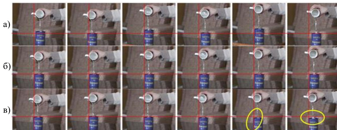
Фиг. 36. Нашият резултат за стабилизация в статичен фон в сравнение с този от ААЕ: а) оригинални видео кадри; б) нашият резултат чрез “3×3OF9×9” метода; в) ААЕ стабилизацията.
